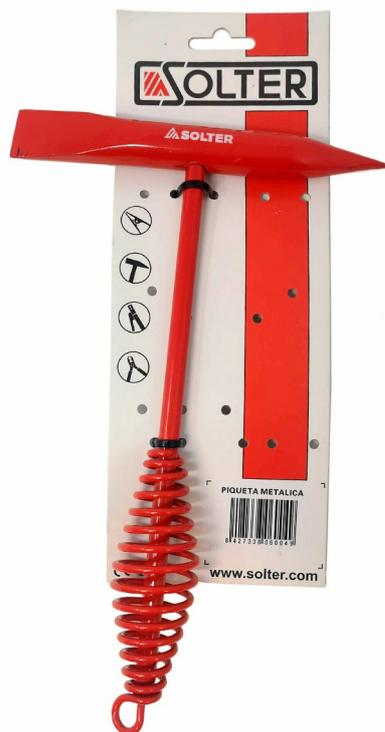
❓ La **Piqueta Metálica Solter** es una herramienta diseñada para facilitar la limpieza de escoria en soldadura, gracias a su mango en espiral que absorbe vibraciones y mejora el agarre. Su doble extremo, con un cincel plano y otro cónico, permite acceder a zonas estrechas y realizar una limpieza precisa. Fabricada en acero de alta resistencia, es ideal para soldadores profesionales y aficionados que buscan calidad y durabilidad. ¡Optimiza tu trabajo con la garantía Solter!
