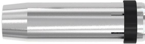
La **Tobera SX-36** de Solter está diseñada para ofrecer una protección eficaz y duradera del baño de fusión en soldadura MIG/MAG. Sus generosas dimensiones de 83,20 mm de longitud y diámetro de 24 mm aseguran una cobertura completa del gas protector, evitando contaminaciones por oxígeno o nitrógeno. Fabricada con materiales de alta resistencia térmica y mecánica, es ideal para trabajos intensivos.
